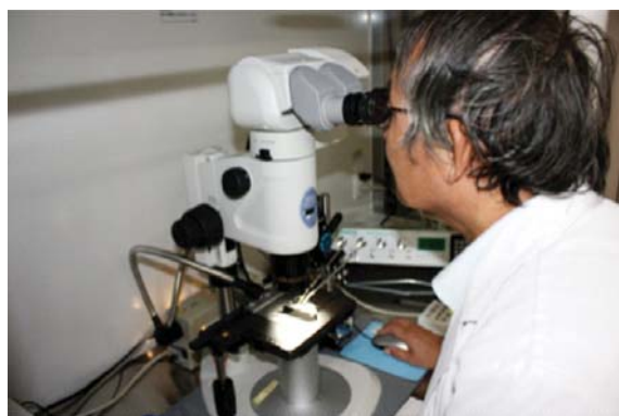
在解剖顯微鏡下進行微注射轉殖
