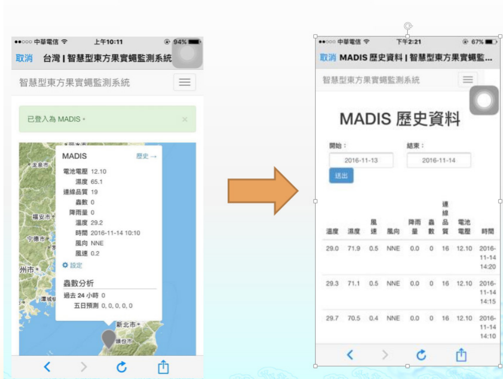
圖 70、無線監控後端即時資料顯示與歷史紀錄追蹤。
