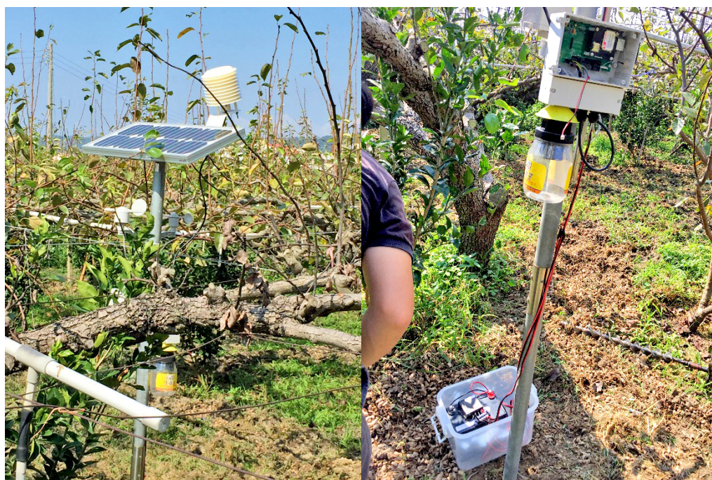
圖 69、東方果實蠅太陽能誘捕感測器。
