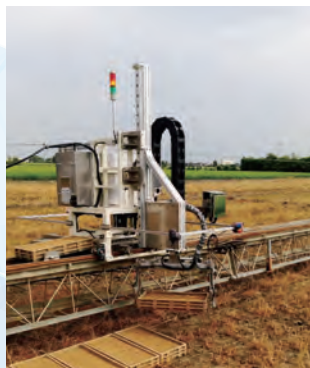
▲ 水稻秧苗盤機械手臂取卸系統（農糧署提供）
