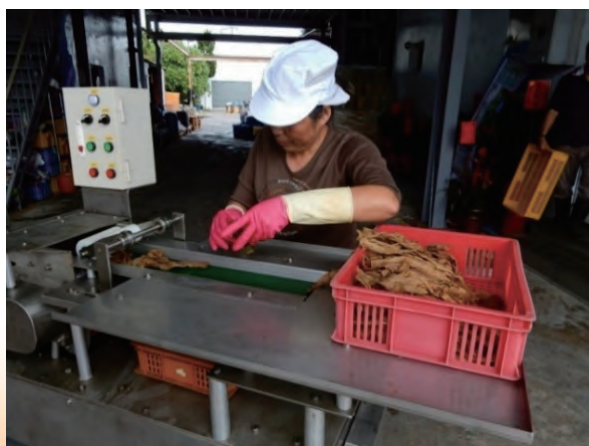
圖78、左為將福菜餵入福菜切割(條)機運作方式，右為人工與機械材切後成品。
