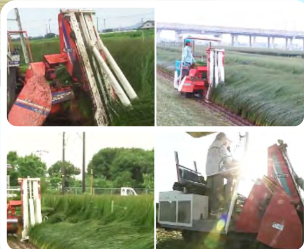
▲ 日本蘭草機械收穫機作業程序，夾草捲入後切割後送堆疊，即使倒伏的也可以收割
