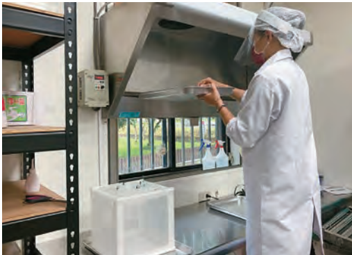
● 改良式抽油煙機排除鱗粉（左）；成蟲飼育箱將固定數量蟲蛹懸掛箱體上蓋（右）
